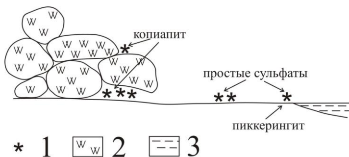
Рис. 2.30. Схема распространения сульфатов на отвалах Яман-Касинского месторождения. 1 – сульфатные агрегаты; 2 – глыбы метасоматитов; 3 – мочажина. Примечание: простые сульфаты – сульфаты состава MeSO_4 \times nH_2O , n = 1-7
