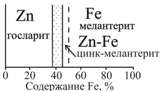
Рис. 1.4. Бинарный твердый раствор между синтетическими семиводными сульфатами, осажденными при комнатной температуре [по Aslanian et al., 1972; Balarew et al., 1973; Siebke et al., 1983 из Alpers et al., 2000].
