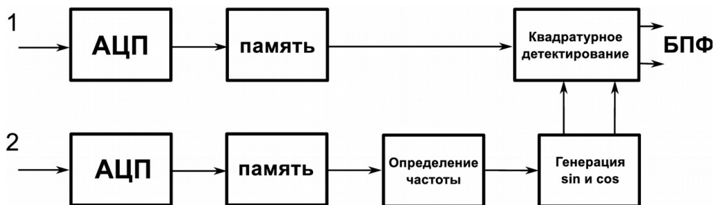
Рис. 3.2. Принцип обработки сигналов двухдатчикового ЯМР-спектрометра.
