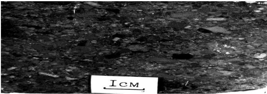
Рисунок 4.11а – Известняк сложенный обломками биогенных карбонатов из инт. 5844-5851 м Ахтубинской скв.№1 (P 1ar2 ) – продукт гравитационного переноса.
