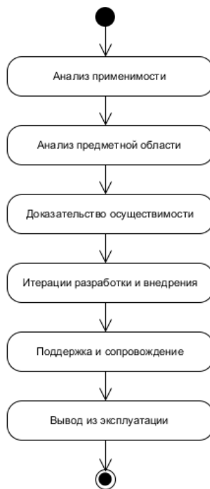
Рис. 3.1: «Классическая» методика разработки визуального предметно-ориентированного языка.
