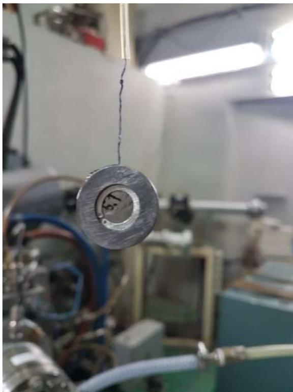
Рисунок 66 – Держатель мишеней - танталовая подложка (толщина 400 мкм), в которую вставлены фольги-мишени, а также фольги для мониторинга параметров пучка. Прижим фольг осуществляется специальным алюминиевым кольцом
