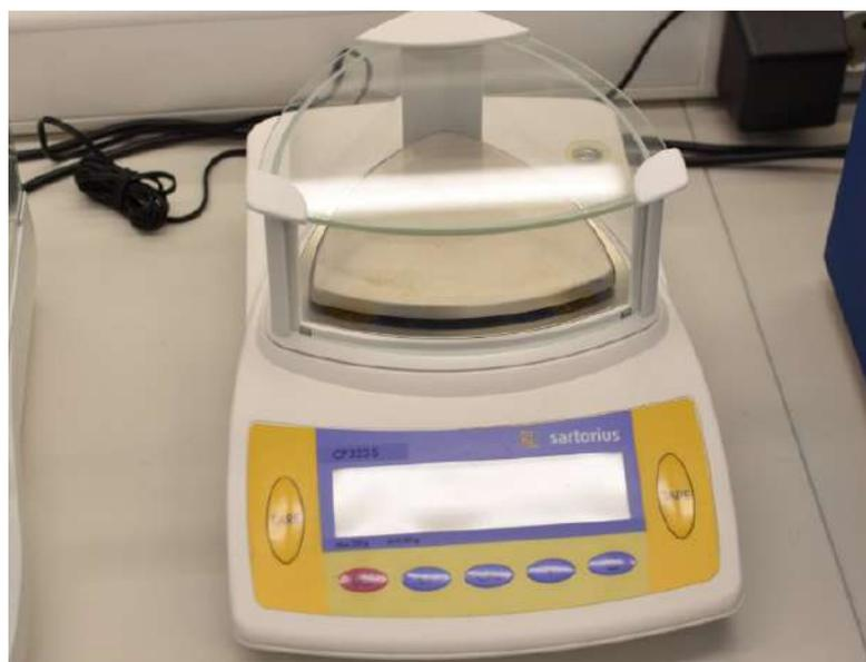
Рисунок 2.3 — Микробиологические весы для взвешивания
