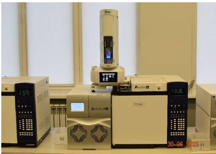
Рисунок 2.6 — Газовый хромато-масс-спектрометр Маэстро-αМС
