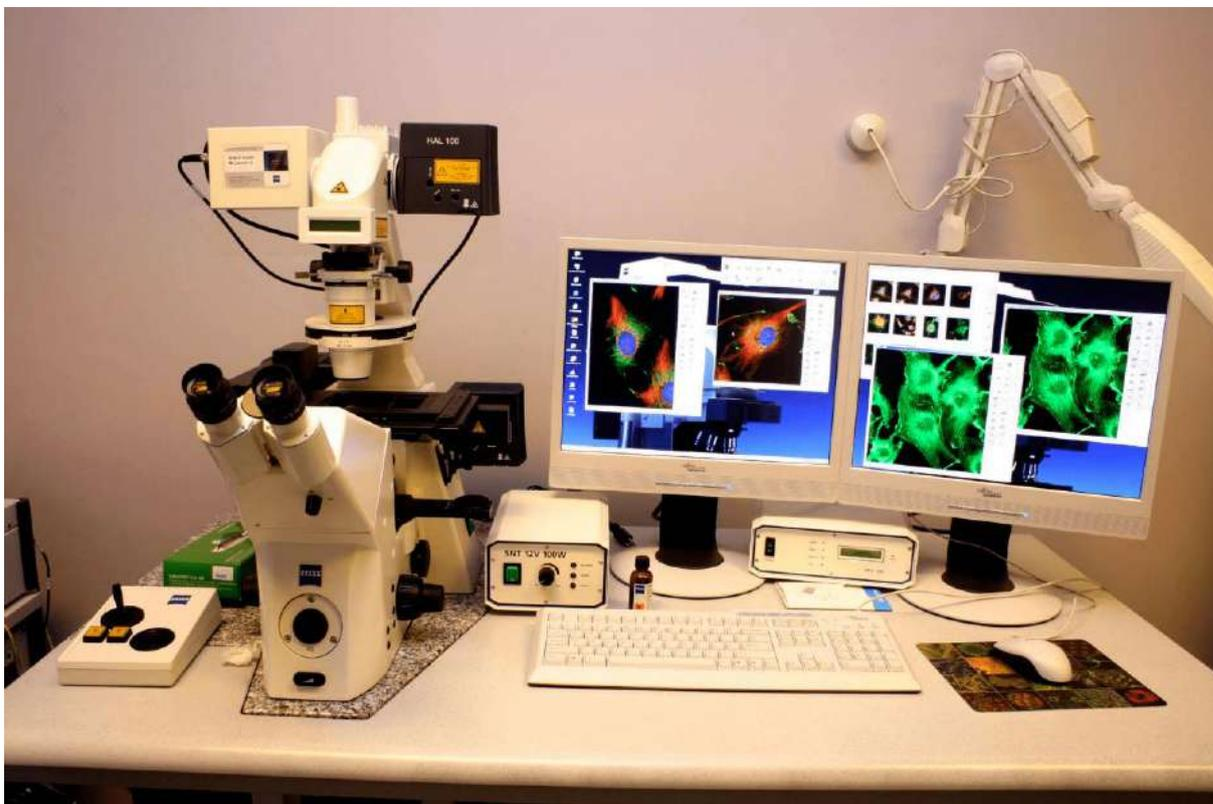
Рисунок 2. Система лазерной иммунофлуоресцентной сканирующей конфокальной микроскопии
