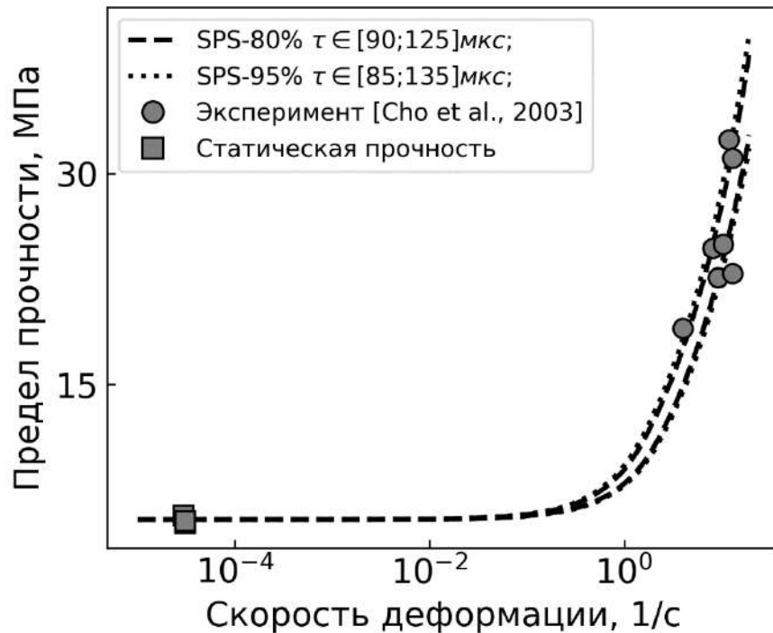
Рисунок 1.4 Скоростная зависимость прочности на растяжения для гранита [101]. Расчётные значения: пунктирная линия – \tau_{0,8} \in [90; 125] мкс, штрихованная линия – \tau_{0,95} \in [85; 135] мкс, \sigma_c = 5.4 МПа.
