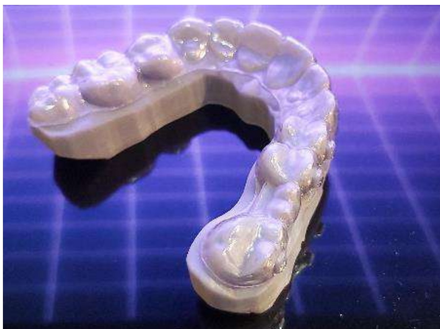
Рисунок 139 - Термоформированный и обрезанный элайнер по напечатанной модели
