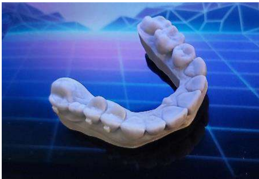
Рисунок 138 - Напечатанная трехмерная модель на 3D SLA-принтере Anycubic Photon S после обработки в изопропанолe и ультрафиолетовой засветки.
