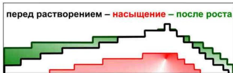
Рисунок 3.9 – Три профиля одного холмика по данным АСМ: за час до точки насыщения перед растворением (белый профиль), в точке максимального растворения (красный профиль) и через час роста (зеленый профиль)
