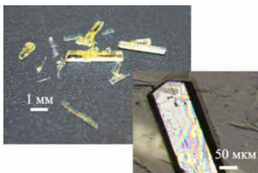
Все *in-situ* эксперименты в работе проведены на растворах и кристаллах диоксида (гидроксиметилхиноксилдиоксида,  $C_{10}H_{10}N_2O_4$ ), который впервые введен автором в практику ростовых исследований (Пискунова, 2011).
