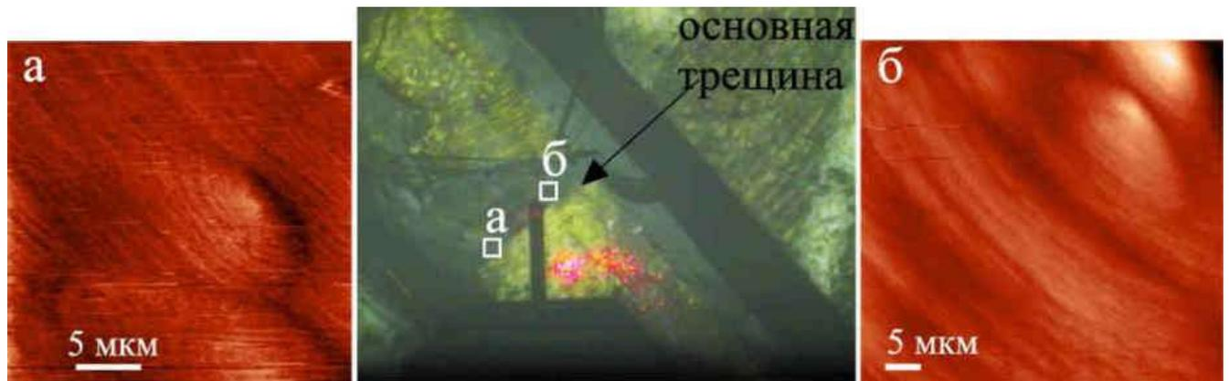
Рисунок 3.62 – Цепочка дислокаций образовавшихся над основной трещиной, снятая в двух ее местах – (а) и (б)
