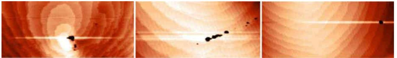
Рисунок 2.25 – Артефакты, генерируемые проваливанием иглы в дислокационные каналы значительной ширины
