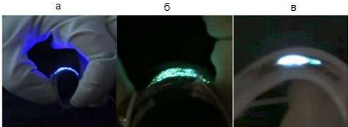
Рисунок 16 – Оптические изображения гибких голубого (а), зеленого (б) и белого (в) светодиодов InGaN ННК/Sylgard 184 в работающем состоянии [31,32,105]
