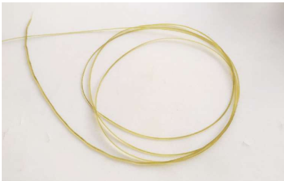
Рисунок 2.15. Филамент, вытянутый из материала ПМВЭ+М1-30
