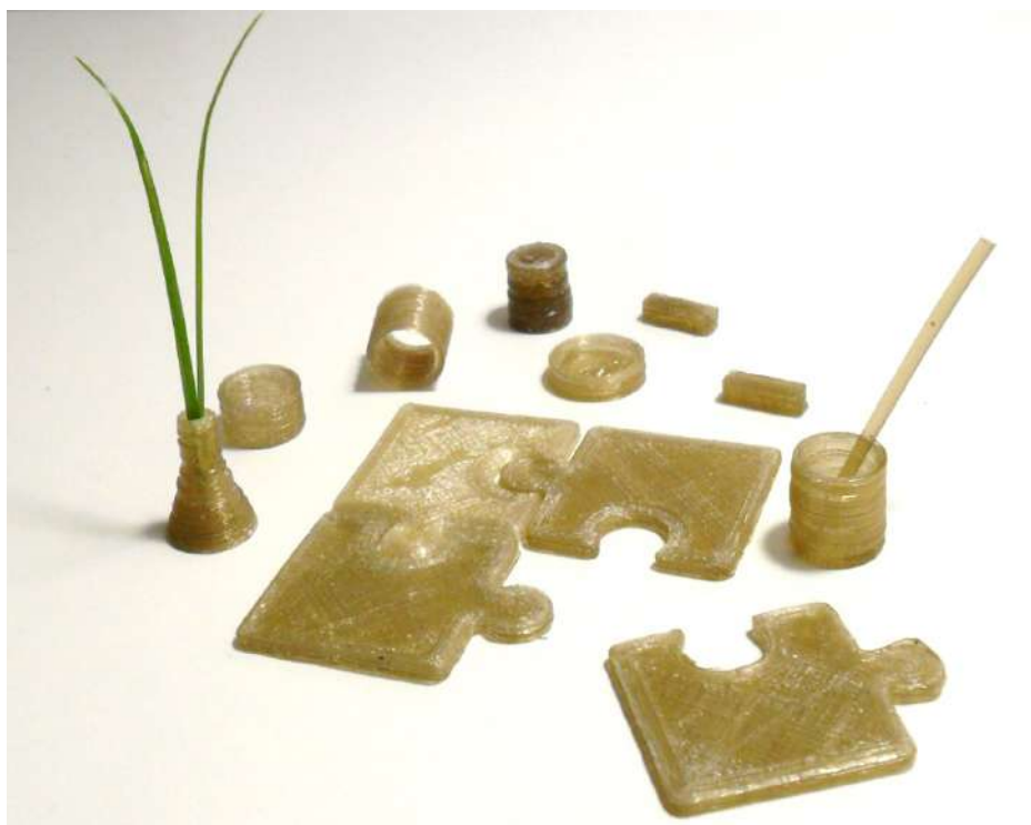
Рисунок 2.16. Объекты, напечатанные на 3D-принтере из материала ПМВЭ+М1-30
