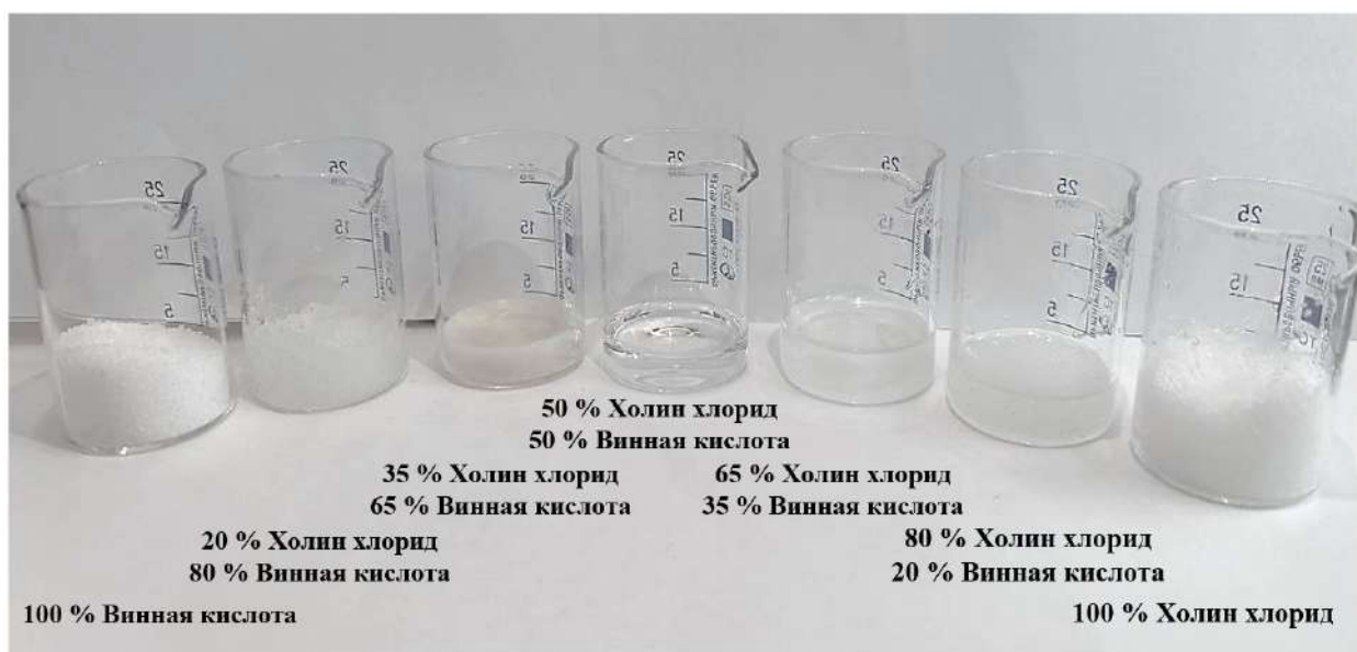
Рисунок 3. Демонстрация эвтектики на примере смесей холина хлорида и винной кислоты при различном соотношении компонентов
