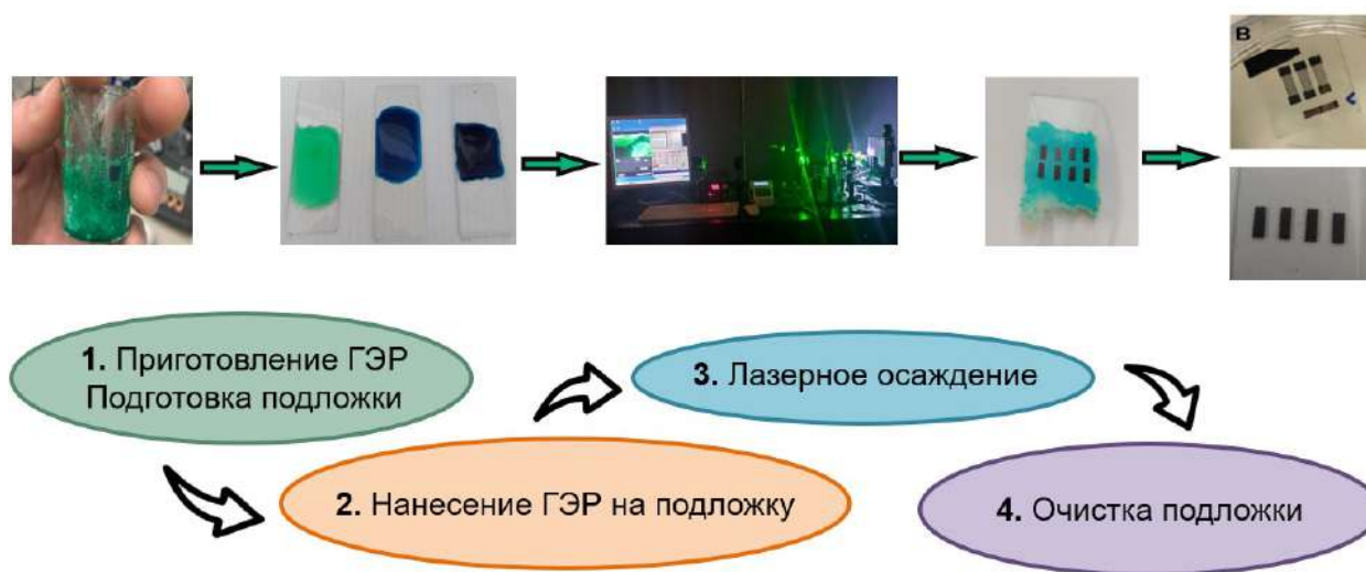
Рисунок 8. Схема процесса синтеза металлических микроструктур из ГЭР на примере меди
