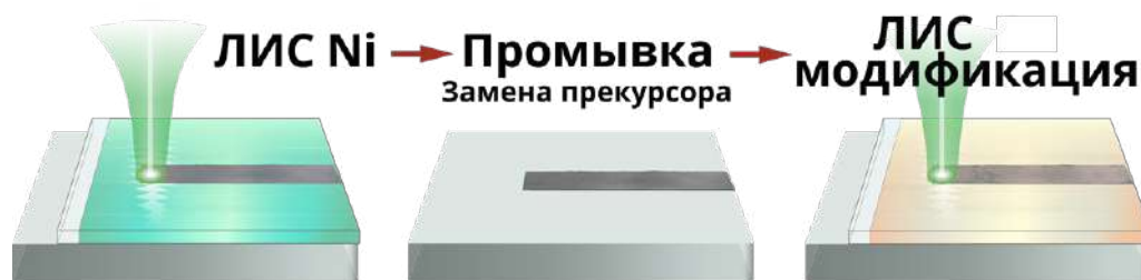
Рисунок 19 – Лазерно-индуцированный синтез на границе раздела подложка – жидкая реакционная среда
