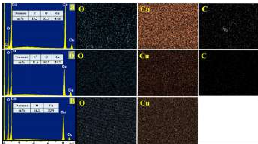
Рисунок 42 – РСМА-картирование поверхности электродов после (а) 15, (б) 150, (в) 600 секунд электрохимического окисления
