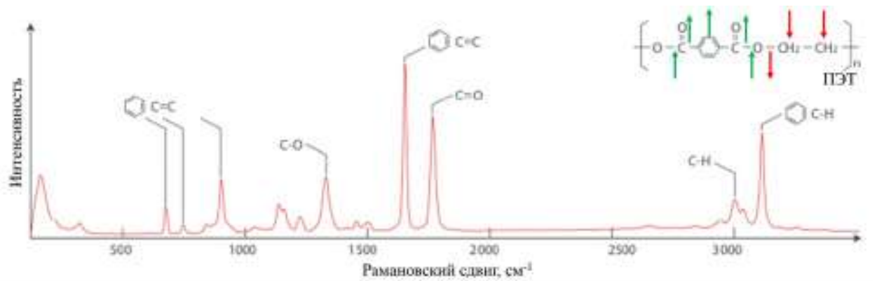
Рисунок 84 – Спектр комбинационного рассеяния ПЭТ. (Зелеными стрелками указаны колебания, интенсивность которых увеличивается при приближении к границе раздела подложка – структура, красным отмечены колебания, интенсивность которых падает)
