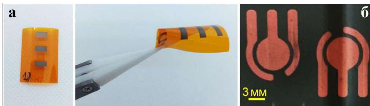
Рисунок 65 – Фотографии (а) Ni-NiO и (б) Cu-Cu x O y электродов, изготовленных на поверхности полиимида (черный фон соответствует области, не подвергшейся воздействию лазерного излучения до процедуры удаления необлученных чернил).
