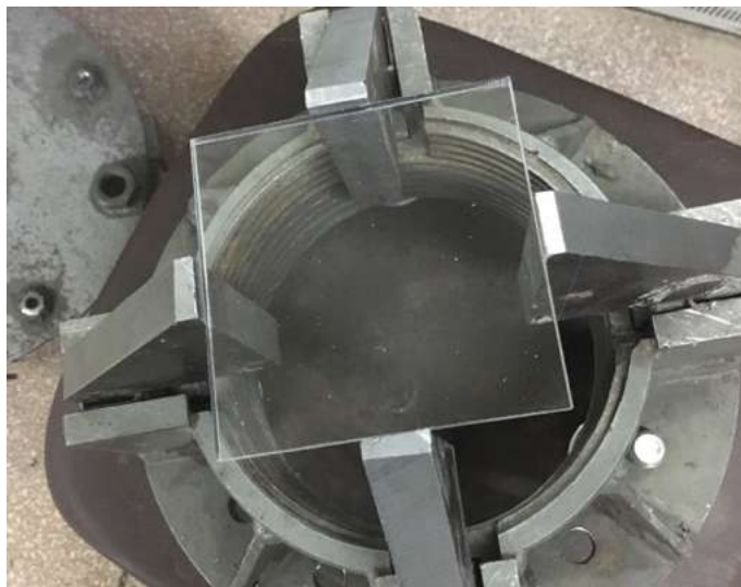
Рис. 5.1. Схема закрепления образца.
