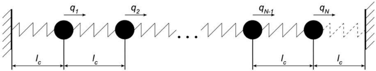
Рис. 3.1. Статически нагруженная цепочка из произвольного конечного числа осцилляторов. Пунктиром обозначено разрушающееся звено.
