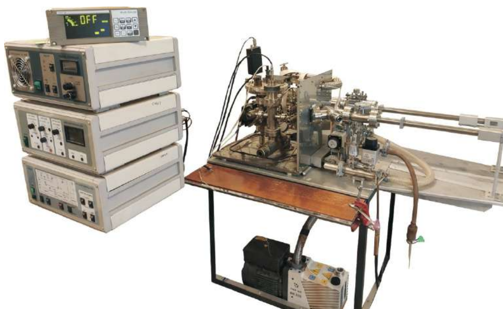
Рисунок. 3.2. – Магнитно-секторный масс-спектрометрический комплекс МСУ-Г-01-М (ИГД РАН)
