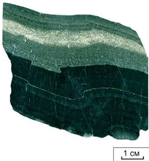
Рисунок 5.2. –Туфогенные породы рудопроявления Карьерное, смятые в приразломной складке (обр. 14/26)
