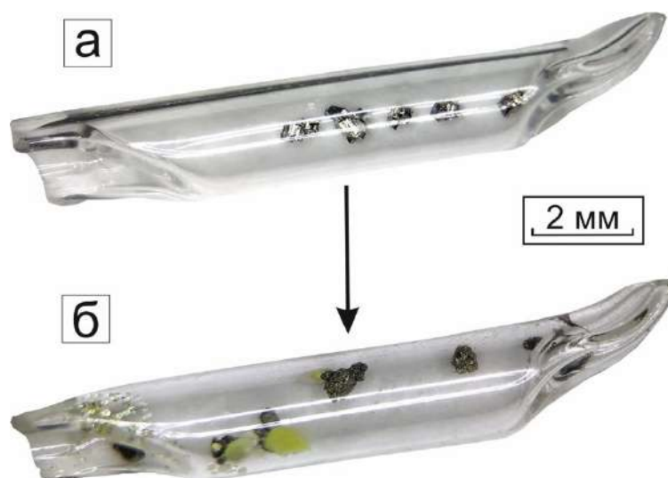
Рисунок. 3.1. – Навеска пирита в кварцевой ампуле. а – пирит до отжига; б – продукты разложения (пирротин и сера) после эксперимента.
