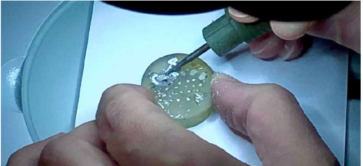
Рисунок 6.4. – Локальный отбор пробы пирита из шайбы алмазным «минибуром»
