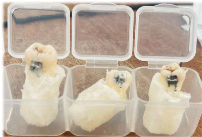
Рисунок 7 Экстрагированные зубы, помещенные в пластмассовые блоки и подготовленные для проведения испытания
