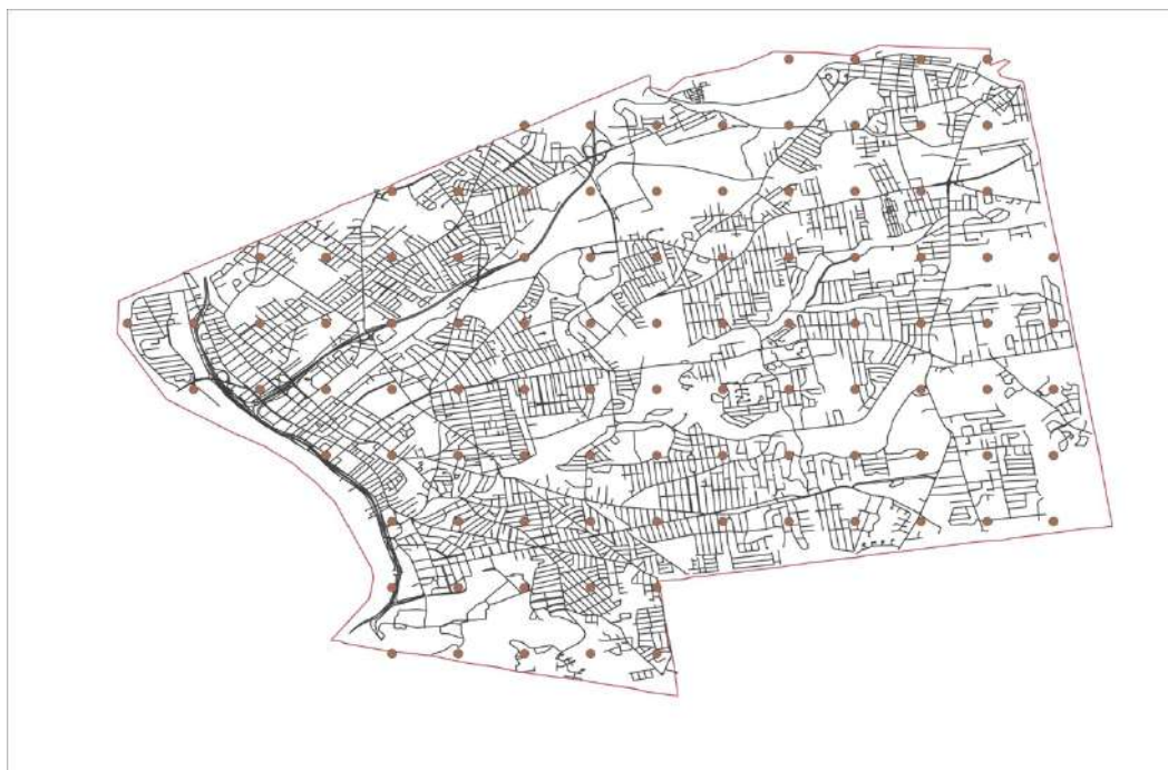
Рисунок 3-1. Сетка из равноотстоящих точек, наложенная на карту Спрингфилда
