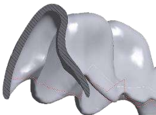
Figure 127 - Uneven anterior aligner thickness
