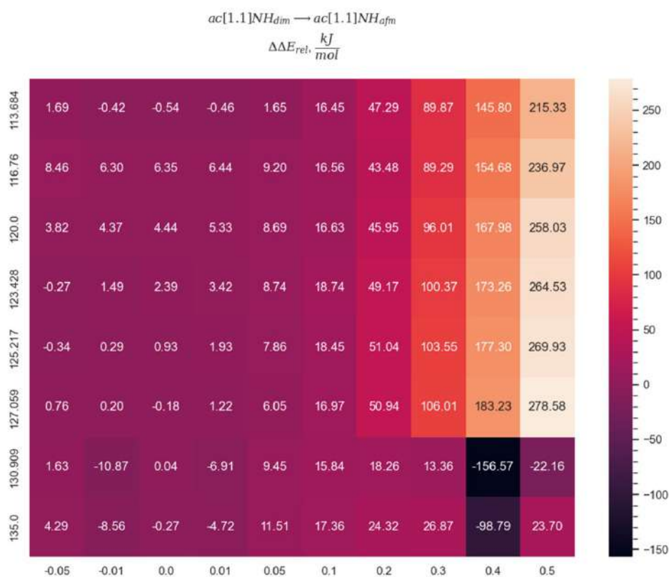
Рисунок 26. Зависимость энергии перехода между различными димерными состояниями исследуемых наногелиценов от торсионных и аксиальных деформаций.
