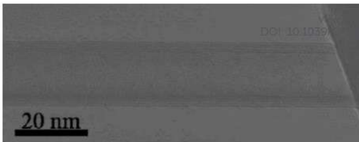
Рисунок 4. Изображение пятистенной WS_2 нанотрубки, полученное с помощью просвечивающей электронной микроскопии высокого разрешения [64].
