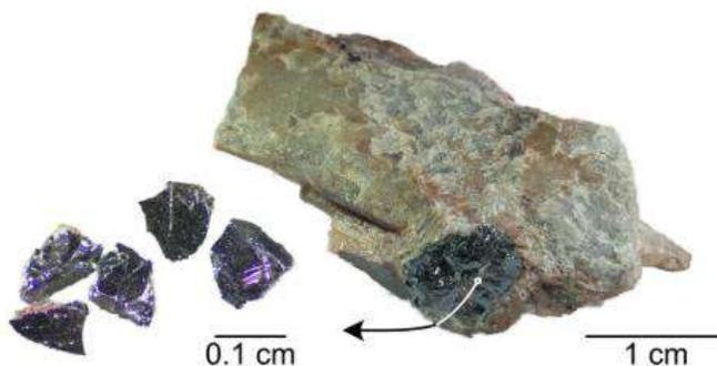
Рис. 60. Метамиктный давидит-(La) (MD) во вмещающей породе и зернах, отобранных для исследования.
