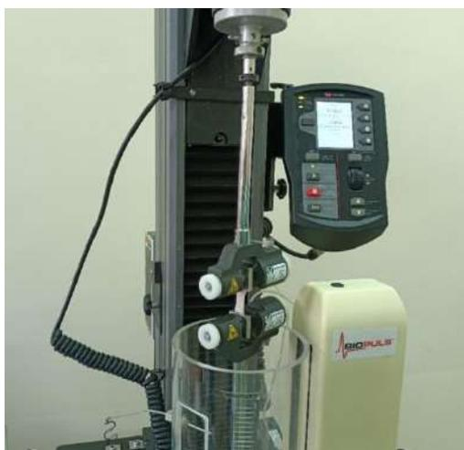
**Рисунок 2.1.1.1 – Проведение физико-механических испытаний образца с использованием испытательной машины Instron 5900**
