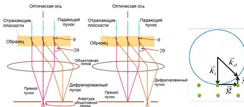
Рисунок 2.2 – Слева – ход лучей в BF и DF соответственно, справа – сфера Эвальда для ПЭМ.
