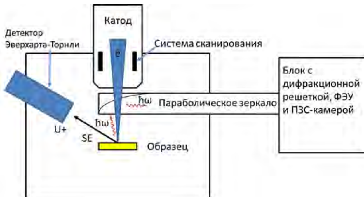
Рисунок 2.7 – Схема установки, используемой в методе катодоллюминесценции, без указания подробностей электронной оптики СЭМ.
