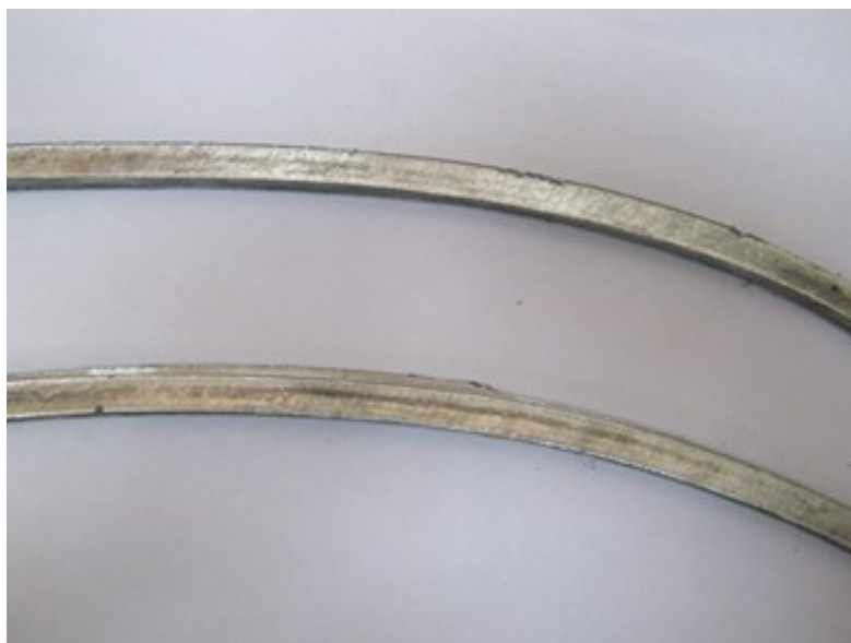
Рисунок 2.2.1. Общий вид заготовок после обработки 4 цикла методом РКУП-К при 130°C по маршруту Вс.
