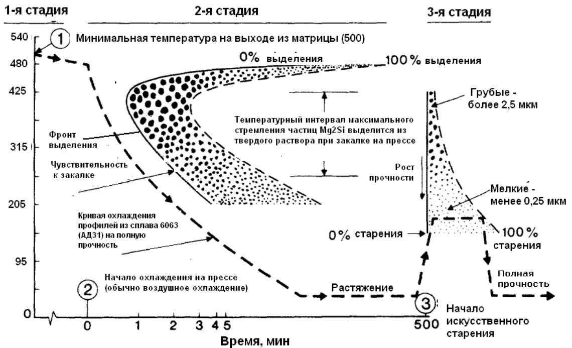
Рисунок 1.2. Схема выделения частиц сплава 6101 разных фаз при старении ( t, \text{мин} - T, ^\circ ) [23].
