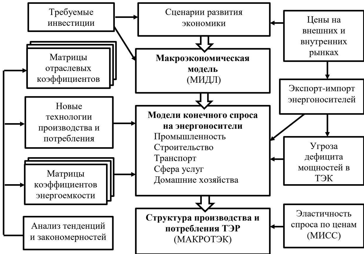
Рисунок 4.12 – Схема оценки макроэкономических последствий и условий адаптации энергетики к разным сценариям развития экономики на базе моделей, разработанных в ИСЭМ СО РАН
