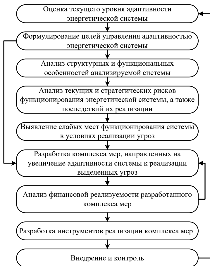
Рисунок 2.9 – Процесс управления адаптивностью энергетической системы
