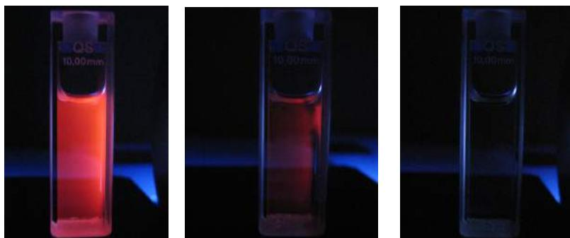
Рис. 3.13. Фотографии кюветы с  $\text{EuPhen}(\text{NO}_3)_3$  в  $\text{CH}_3\text{CN}$  под УФ облучением при постепенном добавлении соли  $(i\text{-Bu})_2\text{PS}_2\text{Na}$ . Происходит образование комплекса  $\text{EuPhen}((i\text{-Bu})_2\text{PS}_2)_3$  и исчезновение  $f\text{-}f$  люминесценции.
