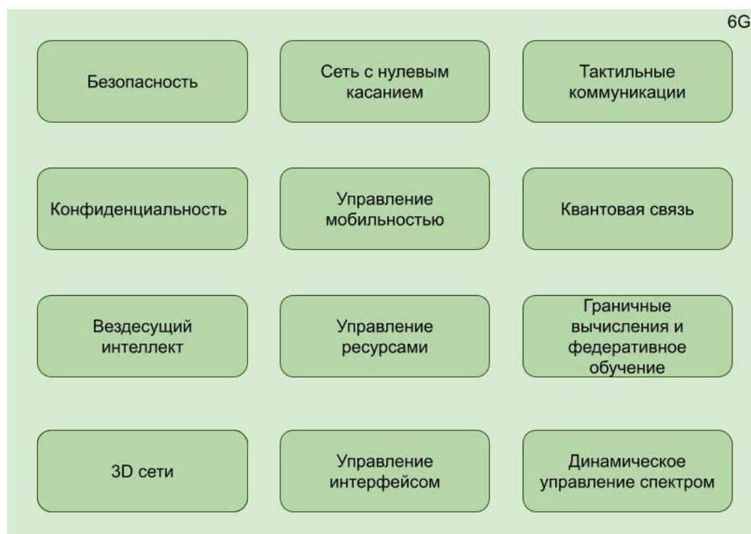
Рисунок 1 - Использование блокчейна для улучшения технических аспектов универсальной системы связи, предусмотренной 6G
