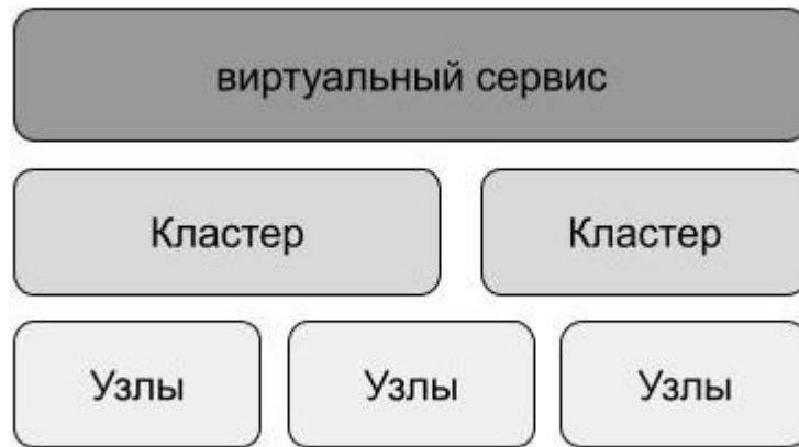
Рисунок 6 - Архитектура виртуального сервера
