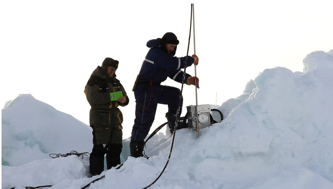
Рисунок 1.8. Буровой пост на склоне паруса тороса. Оператор бурения устанавливает термобур вплотную к измерительному колесу преобразователя на измерительном боксе.
