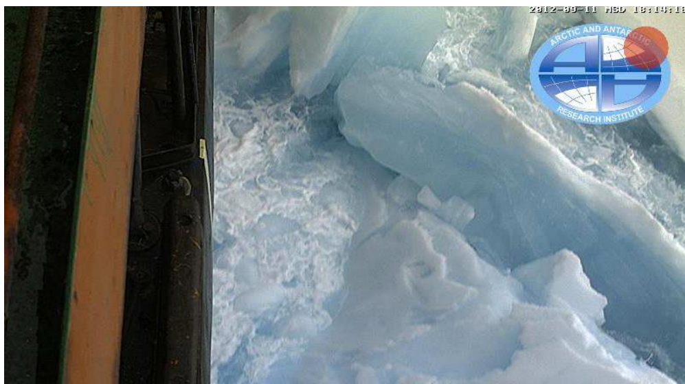
Рисунок 3.52 – Снимок с борта ледокола, иллюстрирующий КС тороса. Хорошо видны блоки льда, смерзшиеся в единый монолит
