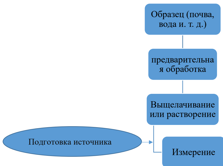
Рисунок 2.2: Общая схема процесса разделения радионуклидов в пробах окружающей среды Предварительная обработка образцов Sr
