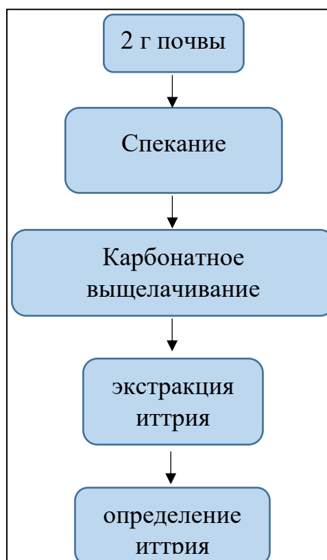
Рисунок 6.7: Схема извлечения иттрия из почвы после спекания, карбонатного выщелачивания и экстракции
