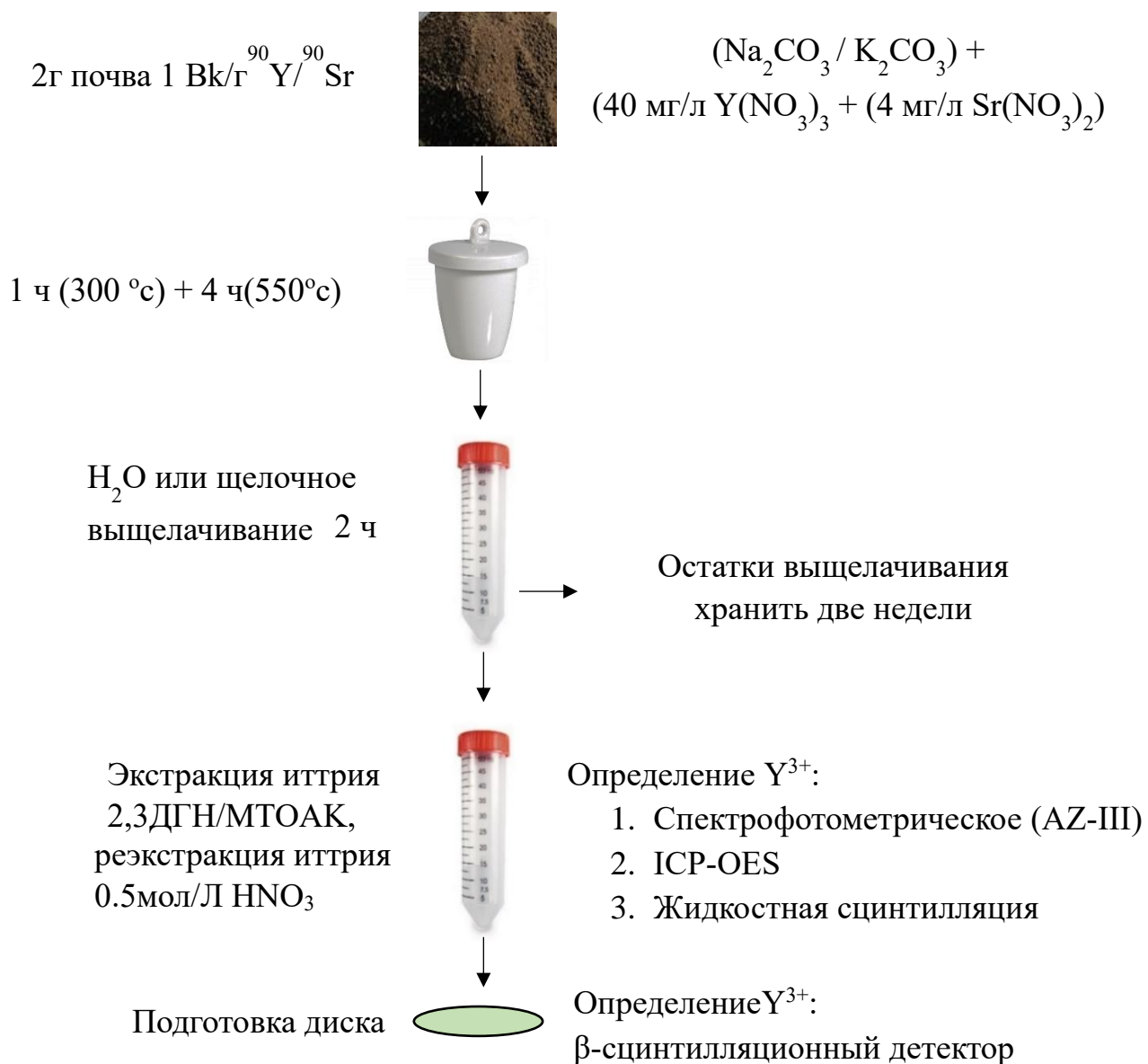
Рисунок 2.4: Предлагаемая новая схема определения ^{90}\text{Sr} по его дочернему ^{90}\text{Y}
