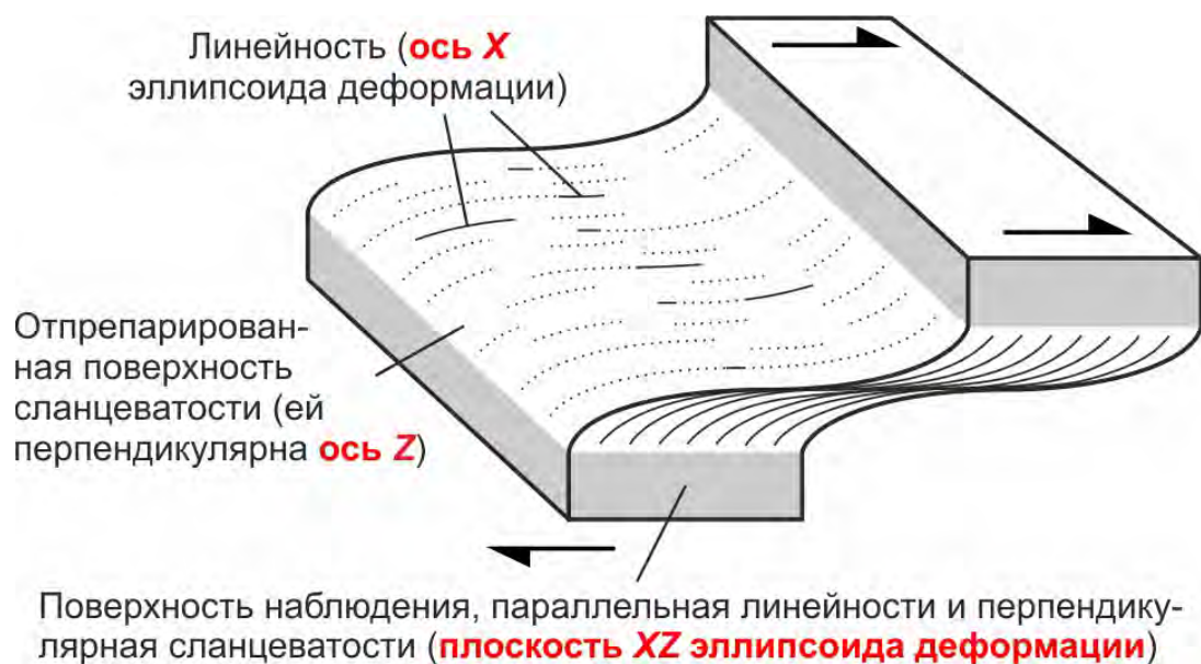
Рис. 3.9. Расположение плоскости XZ эллипсоида деформации относительно линейности и сланцеватости (по работе (Hanmer, Passchier, 1991)).
