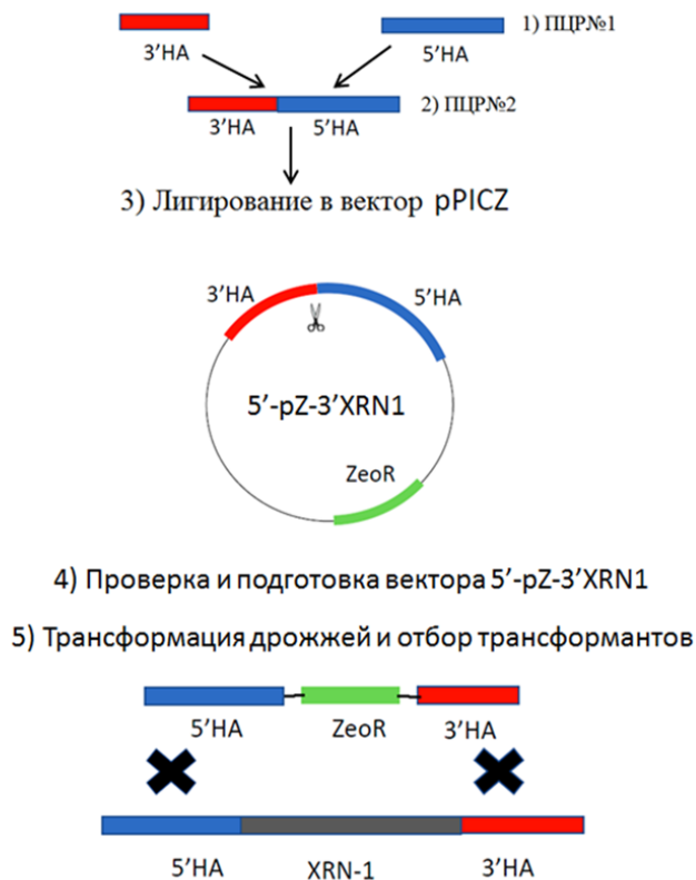
Рисунок 14. Схема экспериментов по внесению делеции в последовательность гена XRN1 у дрожжей S. cerevisiae . Обозначены фрагменты,
