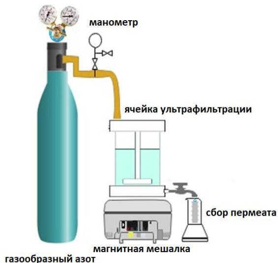
Рисунок 5. Схема фильтрационной установки [238].
