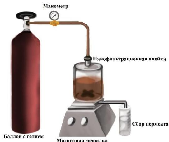
Рисунок 6. Схема нанофильтрационной установки.
