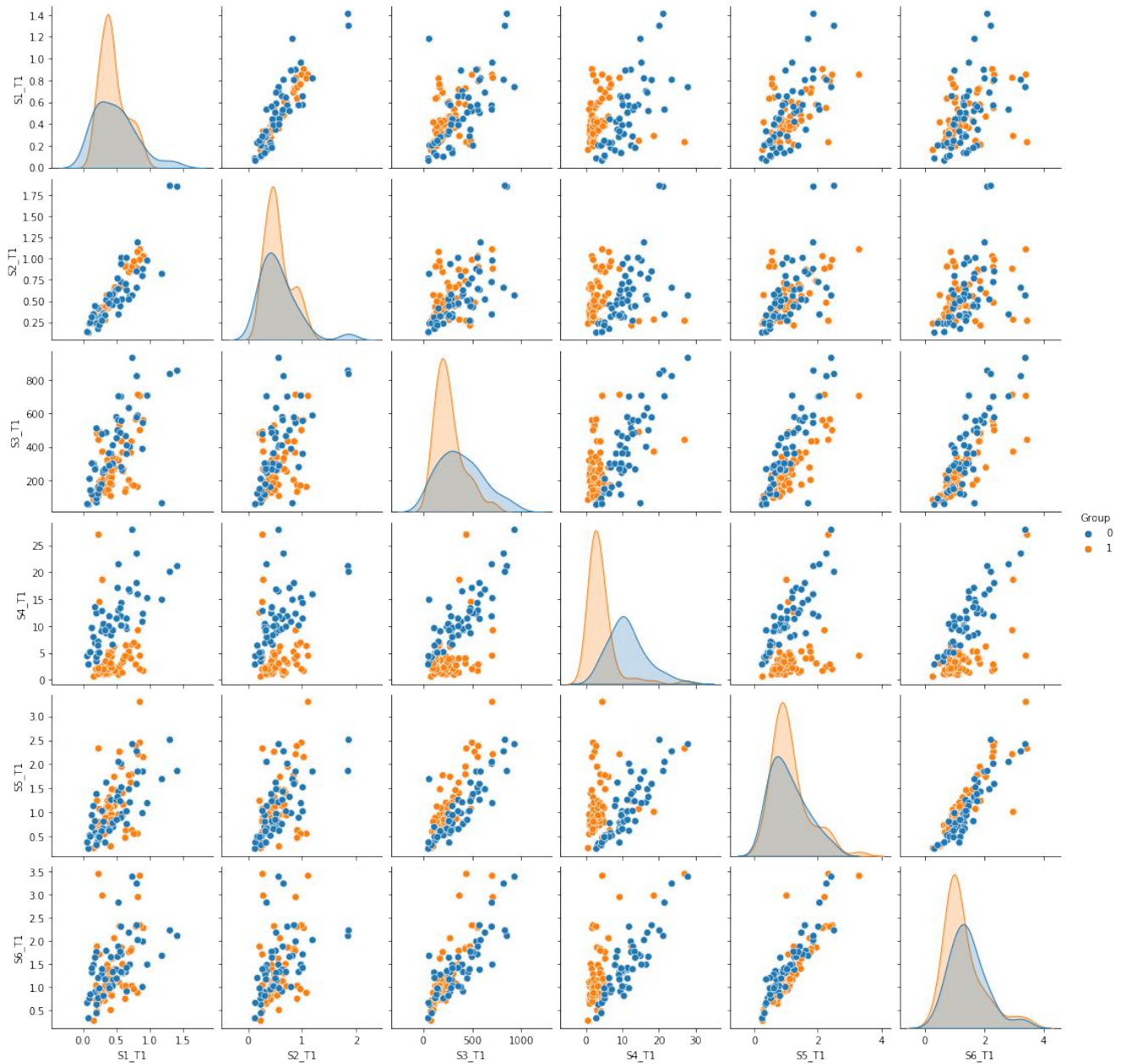
Рисунок 13. Матрица точечных диаграмм рассеяния для 6 сенсоров при температурном режиме T1. В ячейке (i,j) находится точечная диаграмма рассеяния для интеграла проводимости (мкСм×с) i и j сенсоров. В диагональных ячейках (i,i) изображено сглаженное распределение для i сенсора. Принадлежность образца ВВ к группе отображена цветом (синий – контрольная группа (0), оранжевый – группа РЛ (1))
