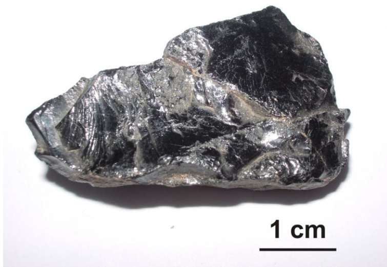
Рисунок 15. Внешний вид одного из выделений исходного метамиктного Y-Fe-ниобата, отобранных в гранитном пегматите в Карелии
