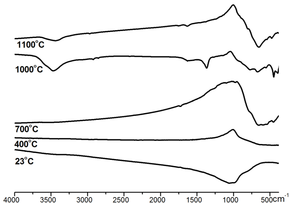
Рисунок 9. ИК-спектры природного Y-Fe-ниобата – исходного образца и фрагментов, отожженных на воздухе при различных температурах. После отжига при 1000 и 1200 °С образцы до анализа хранились в течение 1 месяца в неконтролируемой по влажности атмосфере.
